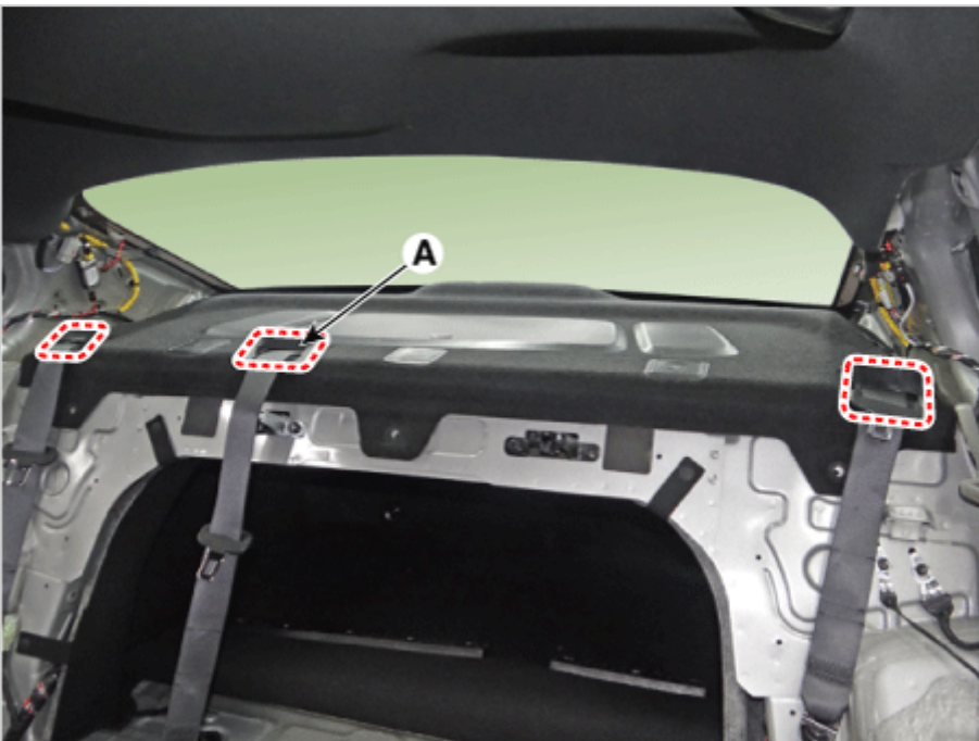
9. 拧下固定螺钉，拆卸后窗台前装饰板(A)。
